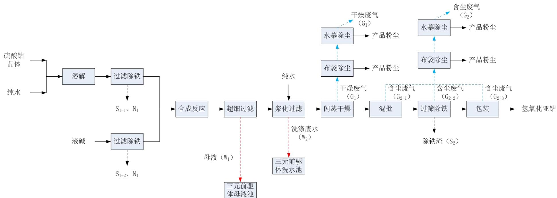
图 3.6-3 氢氧化亚钴生产工艺及产污节点图
