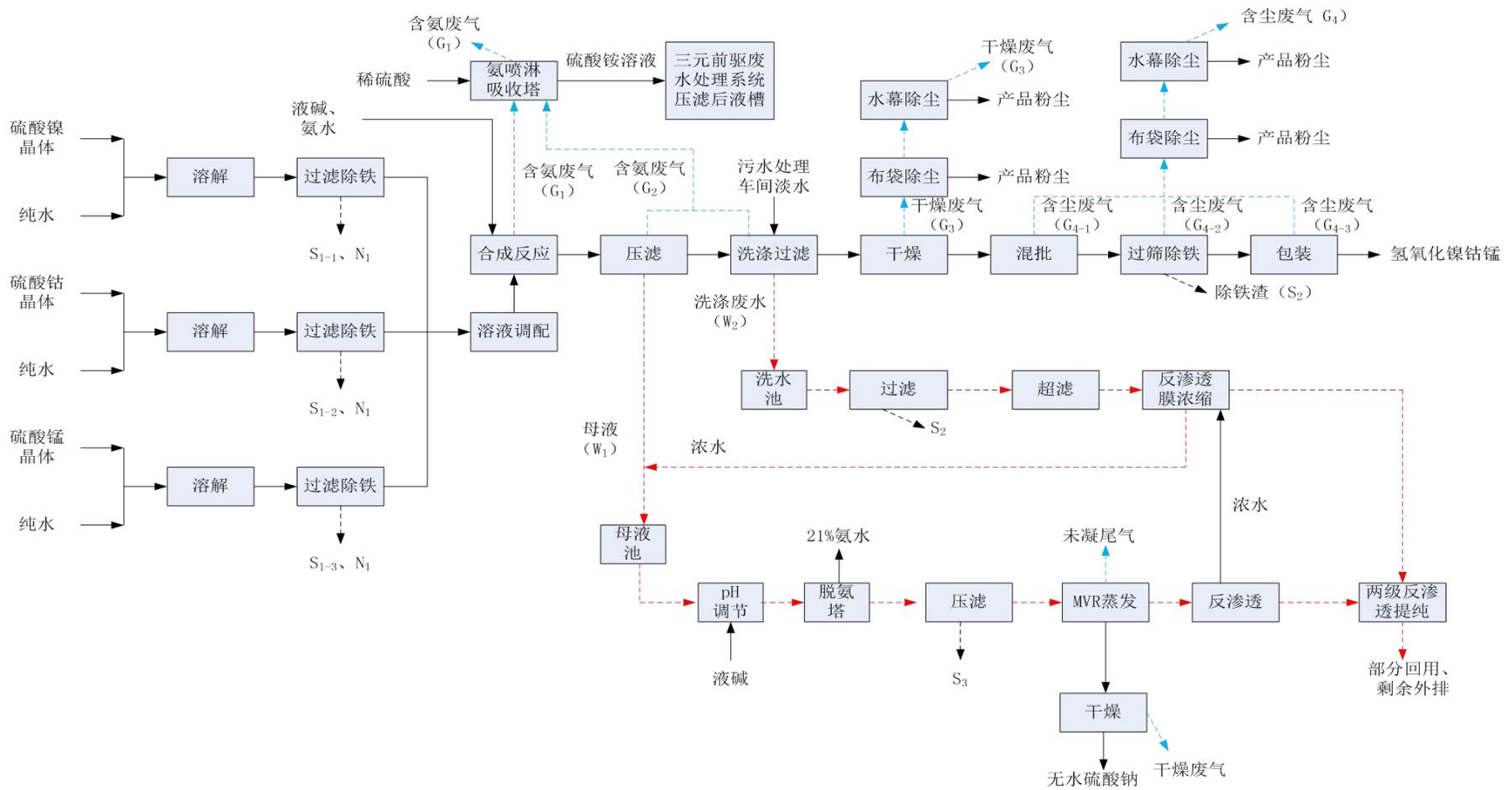
图 3.6-2 三元前驱体生产工艺及产污节点图
