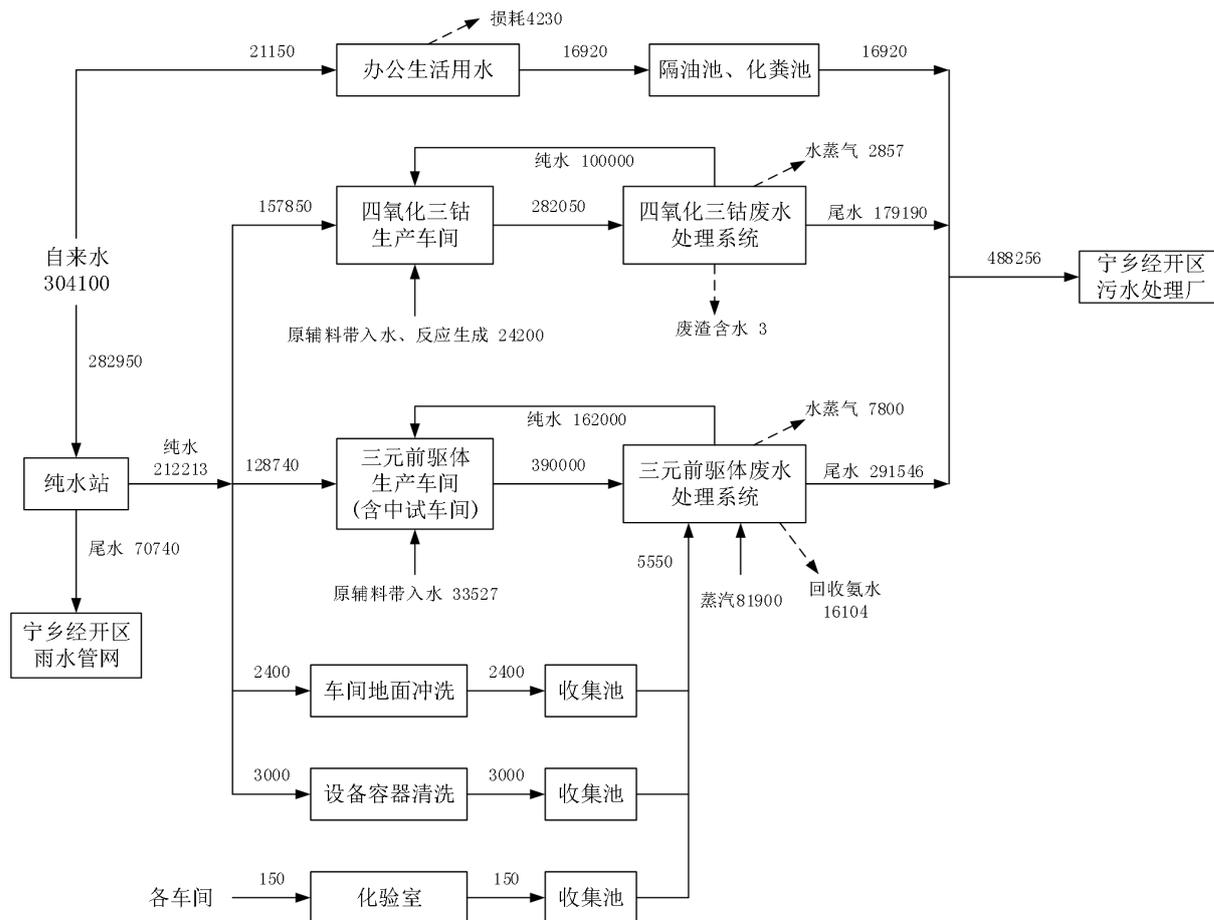
图 3.7-3 一期工程水平衡图
