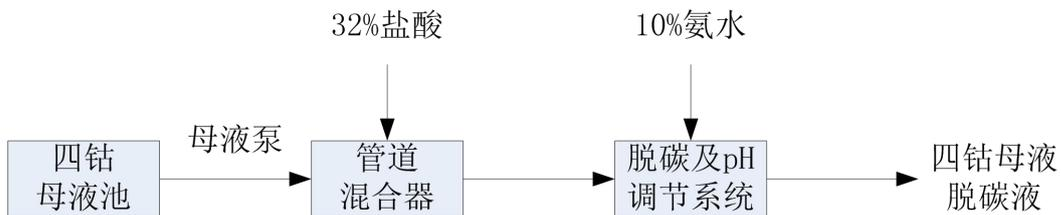
首先往母液中加入一定量的盐酸，将母液的 pH 值调至 4~5 之间，反应一段时间后，母液中的碳酸根和碳酸氢根几乎全部去除，然后往母液中加入一定量的氨水，将废水的 pH 值调至 6~7 之间，待进钴离子回收系统。
