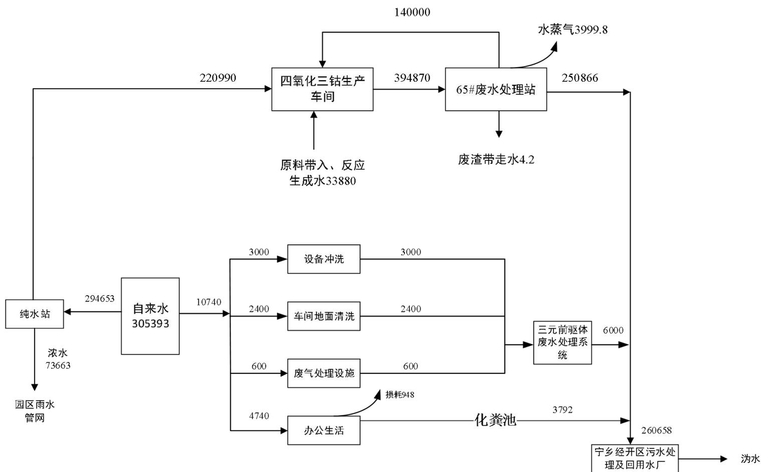
图 5.2-1 项目运营期水平衡图单位: m<sup>3</sup>/a
