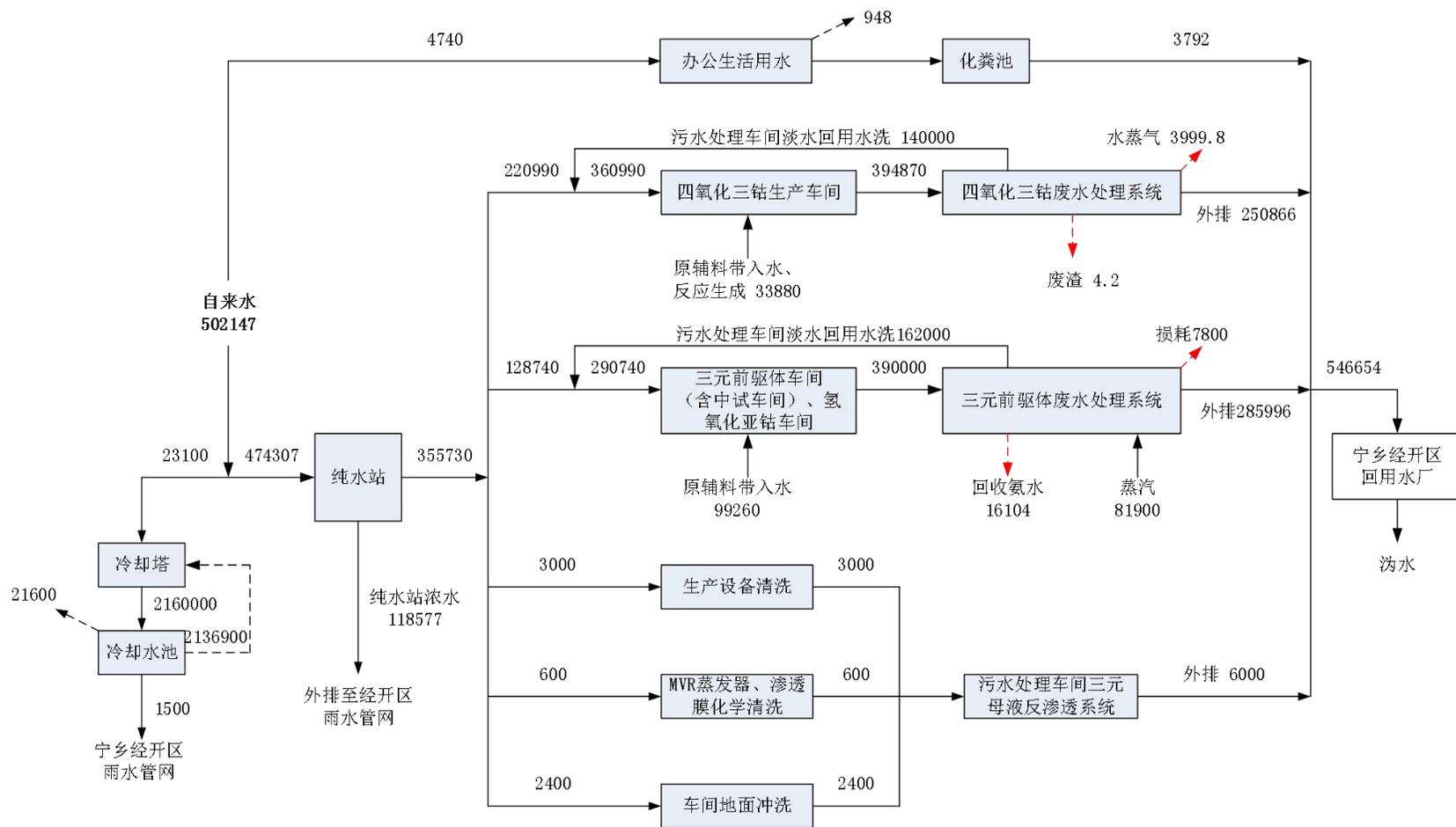
图 5.2-2 扩建后一期工程运营期水平衡图 单位: m³/a
