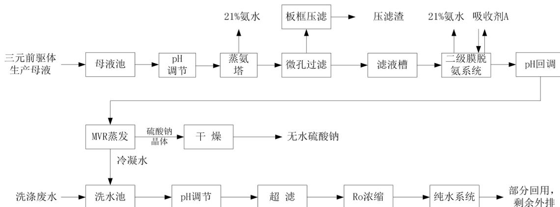
三元母液脱氨以蒸氨塔为主，二级脱氨膜为辅，蒸氨塔与二级膜脱氨系统不共用
