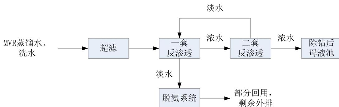
图 10.2-3 蒸馏水、洗水膜浓缩及脱氨气系统
