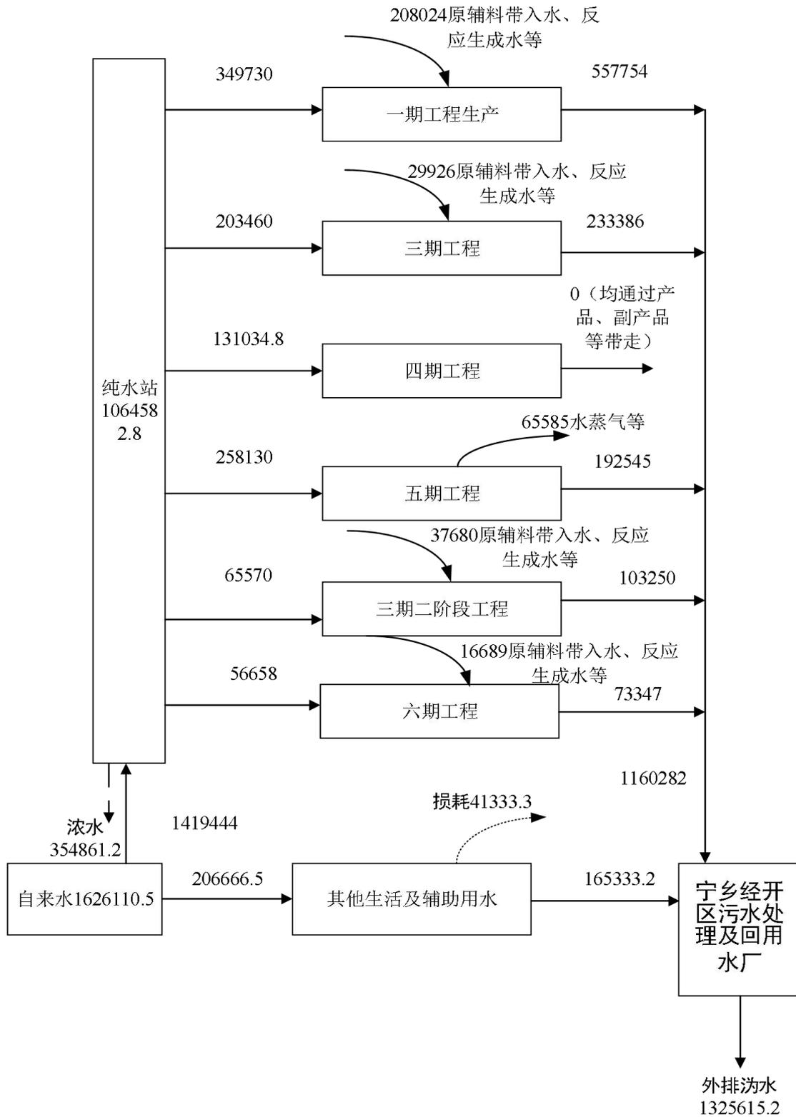
图 5.2-3 扩建后全厂运营期水平衡图 单位：m<sup>3</sup>/a
