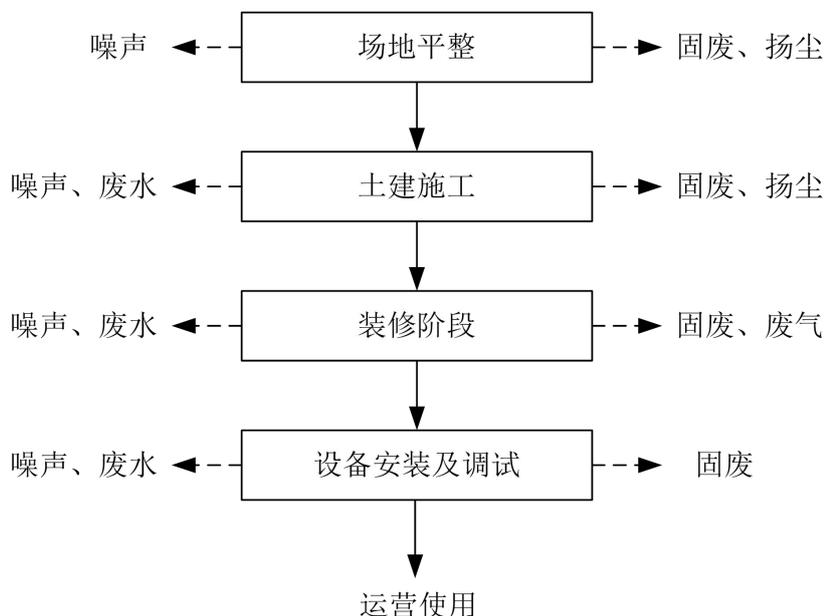
图 5.3-1 项目施工期工艺流程及产污流程图
