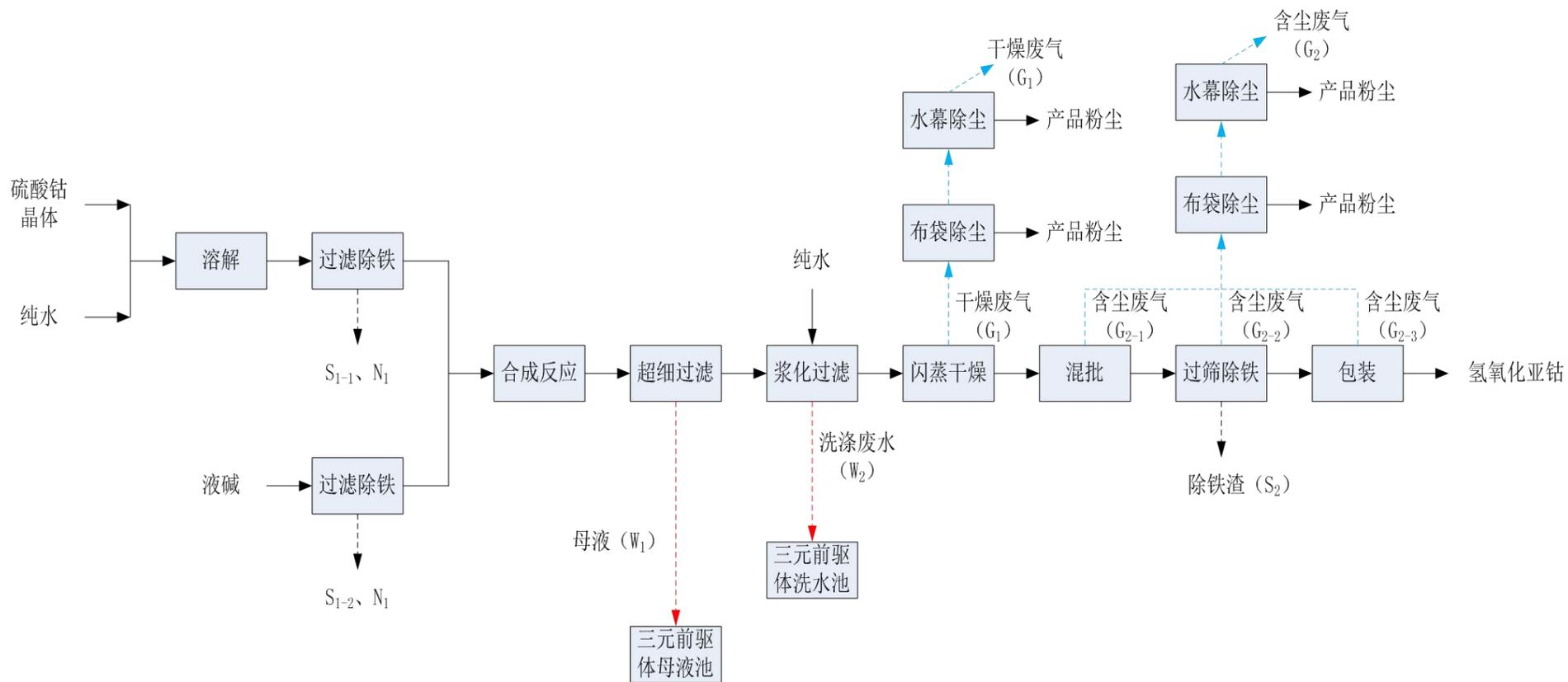
图 3.6-1 四氧化三钴生产工艺及产污节点图
