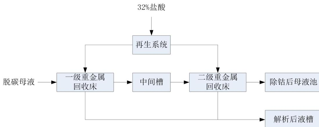
脱碳后的四钴母液，进钴离子回收系统，经重金属回收后，出水钴离子含量控制在 1ppm（1mg/L）以内。钴离子回收系统在保证钴离子回收的同时，又可以保证氯化铵结晶盐的纯度。
